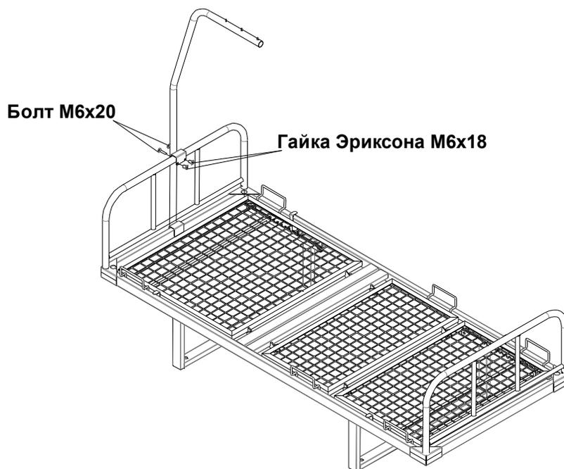
Закрепите штангу на спинке с помощью двух гаек Эриксона М6х18 и болтов М6х20.
